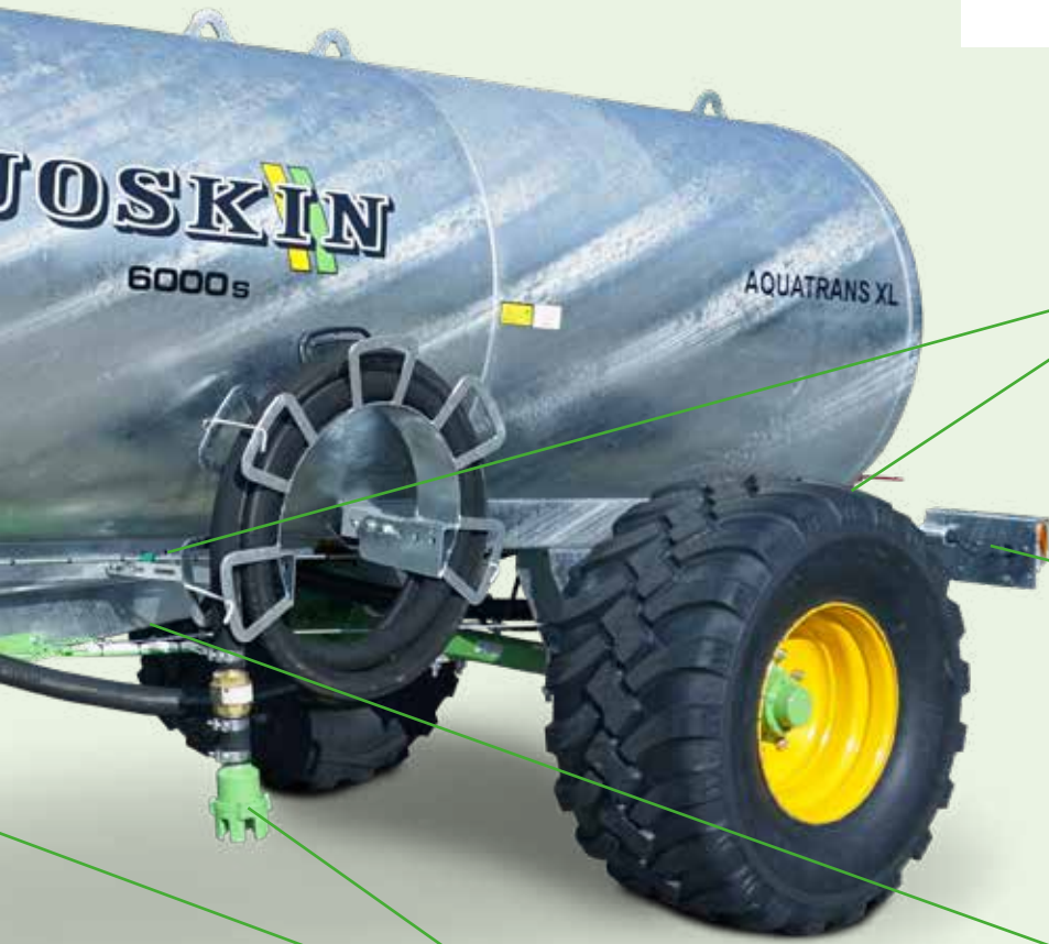
Rückleuchten auf Scharnier, die manuell eingeklappt werden können, um Schäden durch Vieh zu verhindern.
